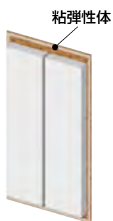
「eパネル」に粘弾性体を 一体化したパネル
